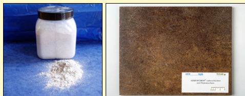
Abb. 1: Pulverförmige Pressmischung (links) Abb. 2: ARBOFORM® - Platte (rechts)
