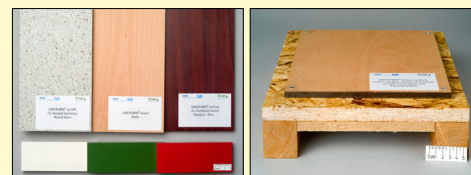
Abb. 5: Beschichtete (HPL, Buchen-Furnier, Deco-Folie Mahagoni) und lackierte ARBOFORM® - Proben (links) Abb. 6: Fußbodenelement mit furnierter ARBOFORM® - Platte auf OSB - Trägerplatte und Faserdämmplatte (rechts)
